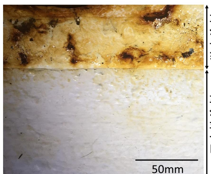
図 塩化物の影響を受ける高速道路鋼製橋脚天端の反応性塗料による補修後の状態。3種ケレンで適用。比較のための従来塗料（下塗り2層+中塗り1層+上塗り1層）では腐食が進行。反応性塗料（下塗り2層+上塗り1層）は高い防食性を示している。
