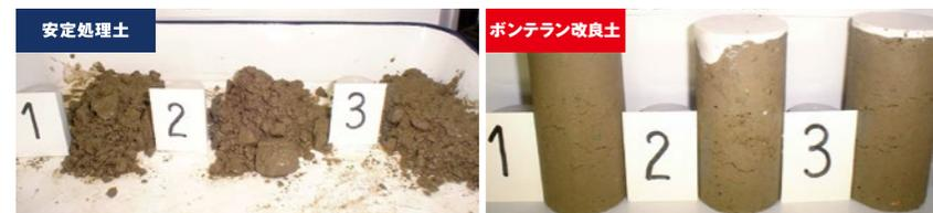
安定処理土の乾湿繰返し試験状況(2サイクル終了時、W=105%)
